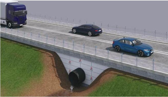
Şekil 3 Yüksek düşey yüklere maruz yer altı boru hatları, drenaj ve altyapı tesislerini koruma amaçlı dolgularda kullanılır.
